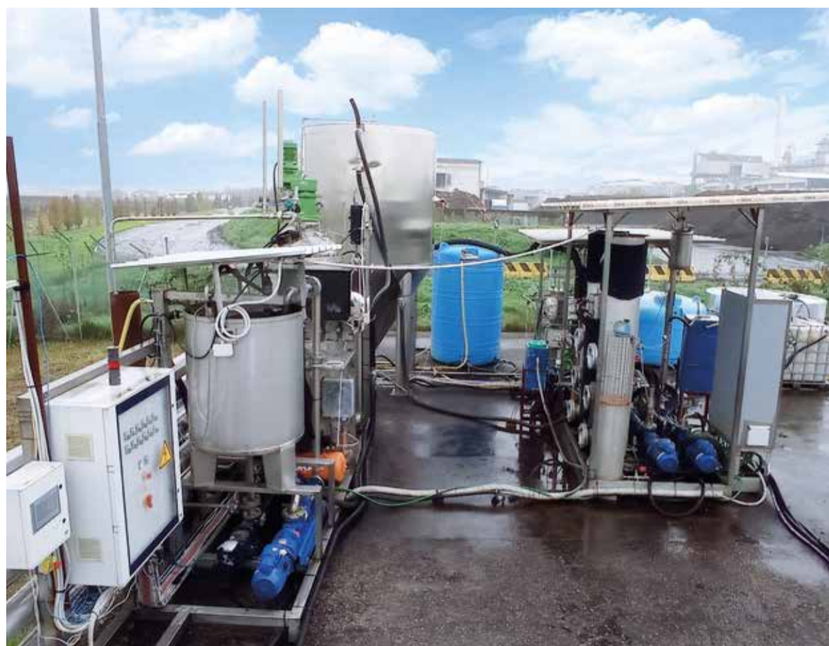
Impianto prototipo installato dalla B-PLAS sbrl in collaborazione con il gruppo Chimico per ottenere bioplastiche a basso costo da fanghi di depurazione e residui agricoli.
