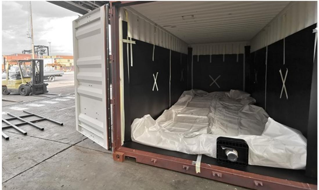
**12 Luglio 2020 - Ravenna** - Tcr ha investito in un ulteriore servizio a valore aggiunto, mettendo così a disposizione degli operatori logistici il riscaldamento dei prodotti contenuti all'interno di flexitank: serbatoi flessibili in polietilene installati in un container per il trasporto dei liquidi.
